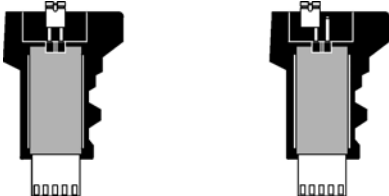
Figure 22 : Réglages du cavalier de la PMC-4 cavalier installé cavalier non installé
