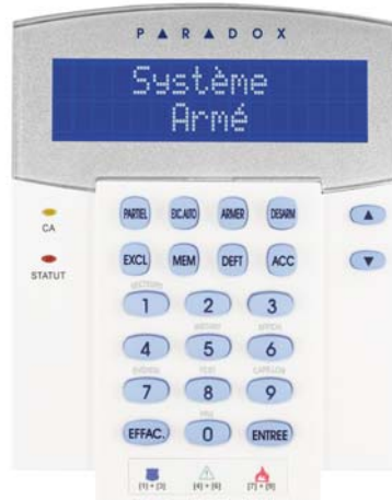
Figure 2 : Vue d'ensemble du clavier à DEL DGP2-648BL
